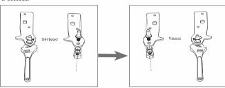
8. Fixez maintenant la charnière inférieure en bas à gauche de l'appareil tel qu'indiqué sur le schéma ci-contre. Revissez les 2 pieds réglables.
