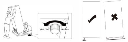
Vous pouvez mettre l'appareil à niveau en ajustant les 2 pieds réglables à l'avant de l'appareil. Si l'appareil n'est pas bien mis à niveau, les portes ne se fermeront pas correctement.
